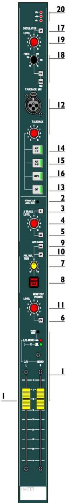
A seção master contém a saída stereo mix, os headphones do operador e saídas de falantes de monitor, um oscilador tes wave pink noise/sine, os controles modo solo e função master solo clear, funções talkback interna;externa e LEDs indicadores de status PSU.
