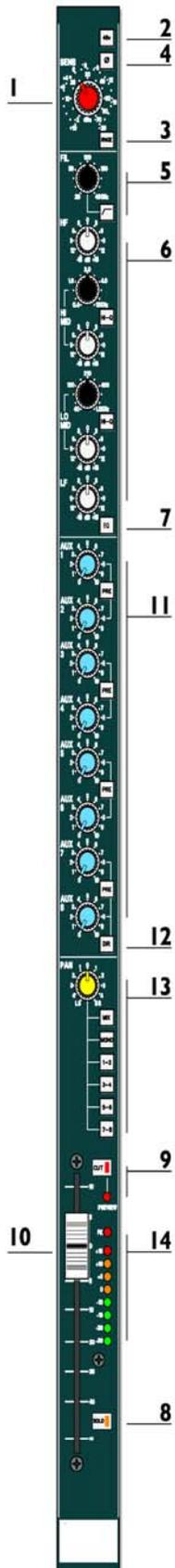
1 **SENS** ajusta a sensibilidade de ambas entradas XLR e HIGH IMPEDANCE (jack HI-Z). Ambas entradas são eletronicamente balanceadas. Sensibilidade da entrada XLR: -2dBu a -70dBu, +10dBu a -20dBu (extensão interrompida). Sensibilidade de entrada de Alta impedância: +10dBu a -20dBu.
