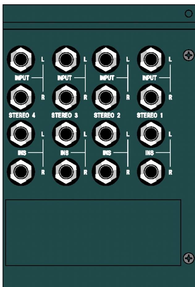
5 O sinal estéreo return é mutado pelo interruptor CUT, e pelo sistema MIDI Muting. Quando o return é mutado do módulo de controle MIDI, o interruptor LED acende. O return é determinado para um mute scene MIDI pressionando o interruptor CUT, então pressionando o botão STORE no módulo MIDI control. O LED PREVIEW é piscado pelo módulo MIDI control quando o modo estiver selecionado, para indicar que o return está determinado para um mute scene selecionado.
