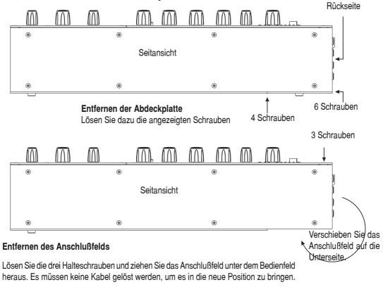
Montieren Sie die Abdeckplatte auf der Rückseite und das Anschlußfeld in seiner neuen Position mit den zuvor gelösten Schrauben.
