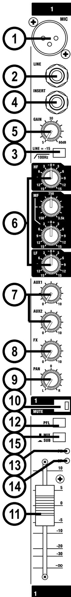
Le départ Send peut aussi servir de sortie directe pré-Fader et pré-EQ, avec la pointe et la bague court-circuitées pour ne pas couper le trajet du signal (voir ci-dessous).
